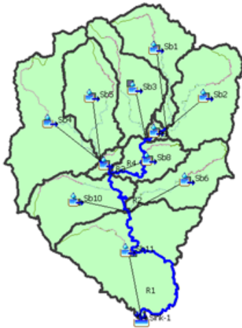
Fig. 14. modelo matemático y parteaguas de la región hidrográfica de parte de la cuenca del río Grande de San Miguel. Fuente: elaboración propia, DOA-MARN.
